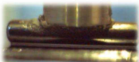
Mesure adimensionnelle à l'échelle millimétrique des forces capillaires pour une interaction cylindre-plan
