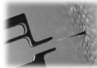
Illustration d'une opération de manipulation d'un nanotube de carbone sous un microscope électronique (Projet NANORAC)
