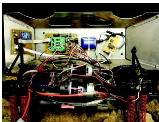
Figure 2.19: Architecture électronique de contrôle-commande embarquée
