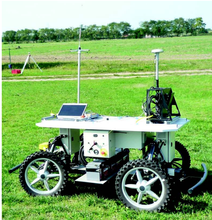
Figure 2.15: RobuFAST A sur site avec sa base DGPS fixe (en haut à gauche)
