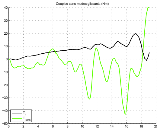
Figure 4.17: Couples sans la commande par modes glissants (Nm)
