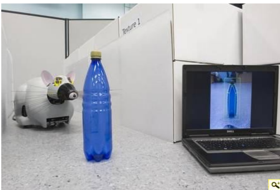
Système de vision du robot : détection bio-inspirée de mouvements, de couleurs et de contours. © Steve N'Guyen et al. , 2008/CNRS Photothèque/ISIR/Rajau Benoît
