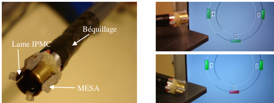
Figure 98: Capteur de contact à base de lames IPMC.
