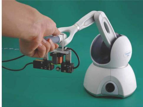
FIGURE 1.12 – Concept de pince haptique sans contact [van West 2007]
