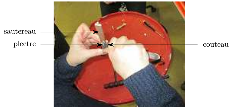
Fig. 4.3 Taillage des plectres dans un atelier de facture de clavecin.
