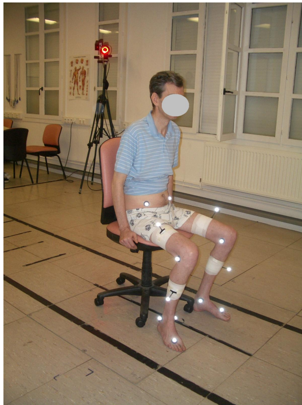
FIG. 6.1 – Un patient utilisant le système "Motion Analysis" de Garche : Marqueurs optiques, capteurs de Forces noyé dans le plancher sous les pieds.
