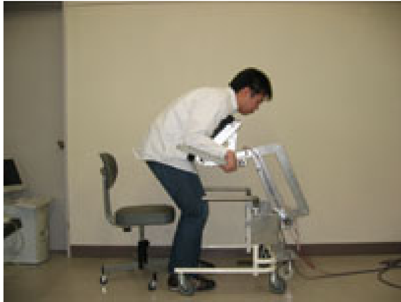
FIG. 1.8 – Robot verticalisateur d'assistance fonctionnelle de l'Université d'Electro-Communications des systèmes d'information de Tokyo.
